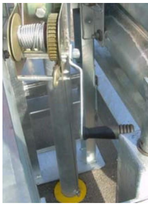
Obr. 5: Pripevnenie lanka navijaka na fixačný kôl
