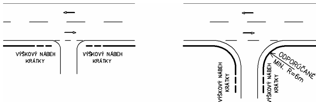
Obrázok 22 - Zvodidlo pri pripojeniach, zjazdoch a križovatkách
