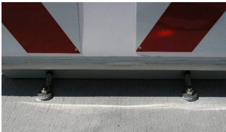
Obrázok 2: Zaistenie fixačných lán pod prednou časťou tlmiča
